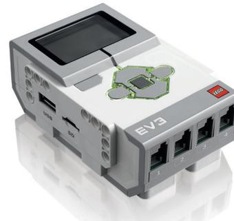
Puertos de entrada. Estos permiten conectar los sensores con el ladrillo.
